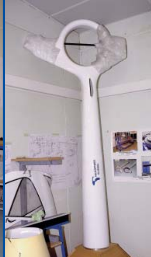
Toute la poutre arrière est un ensemble monobloc ne pesant que 7 kg.
