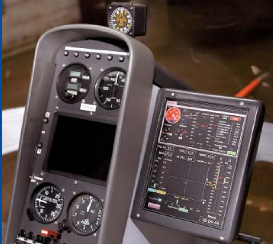
Ce bel écran LCD de 130 x 98 mm à base de dalle matrice active à haute luminosité regroupe les paramètres moteur et autres indications pour la conduite de l'hélicoptère. L'écran de droite sert à l'acquisition des données du prototype.
