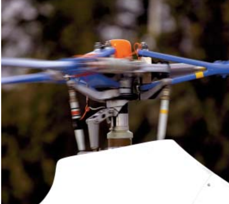
Dans son ensemble, le rotor principal du Cabri ressemble fortement à celui du Colibri d'Eurocopter, une référence.
