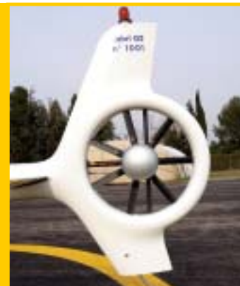
Ce simili Fenestron spécialement développé pour le Cabri a d'ailleurs été breveté dans le cadre des accords entre Guimbal et Eurocopter.
