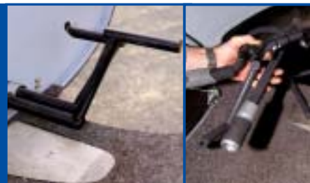
Une astuce permet de démonter les commandes de vol en deux mouvements. Clic-clac, c'est enlevé, plié et rangé dans un petit coffre : c'est magique !
